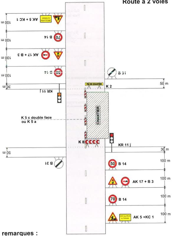
Schéma à appliquer notamment lorsqu l'alternat doit être maintenu de nuit, en absence de visibilité réciproque.
