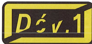
Exemple de panneau de fin de déviation avec le symbole "Dév."
