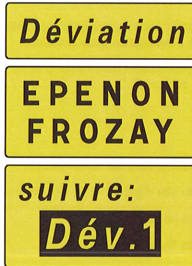
Exemple de panneau KD 79 avec le symbole "Dév." (signalisation au niveau du site d'entrée de la déviation)
